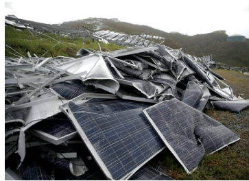
Şekil 1a,b. Dolu, kuvvetli yağmur, fırtına, kızgın güneş gibi kötü hava koşullarına dayanamayan güneş tarlası panelleri örneği ve açık bir çöplüğe atılan hurda paneller
