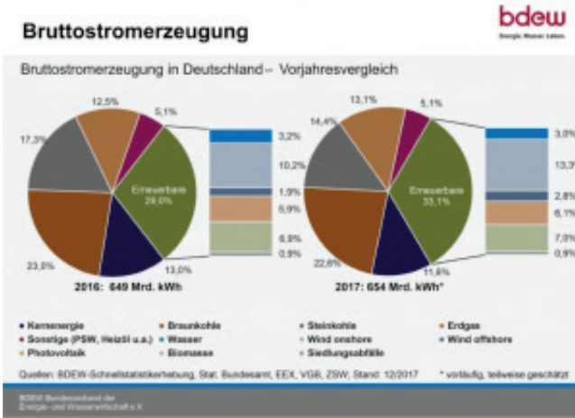
Şekil 2'de Almanya'da 2016 ve 2017 yıllarında üretilen brüt elektriğin enerji kaynaklarına göre dağılımı gösteriliyor. Yenilenebilir enerjilerle (Erneuerbare, YE) elektrik üretiminin, toplam elektrik üretimi olan 654 Milyar kWh'a oranı 2017'de %33,1 değerine yükseldiği görülüyor (Aslında
