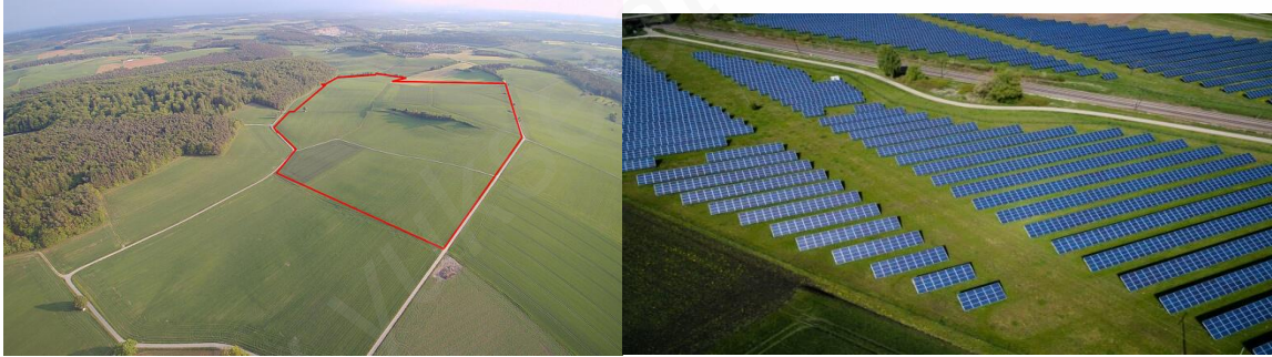
Şekil 1: Almanya’da yapılacak bir güneş santrali için planlanan büyük alan ve toprak yüzeyini pek bozmayan panel dizileri (Aralarda ve yanlarda bırakılması gereken yollar, paneller için gerekli geniş alanı çok daha da büyütüyor)
