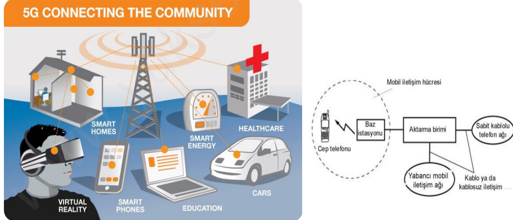
Şekil 1: 5G mobil iletişim ağının ve sağda: her çeşit mobil sistemin temel çalışma şekli
