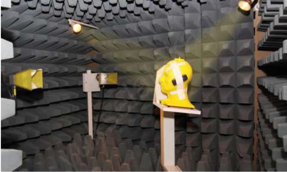
Şekilde, içi, insan başı dokusu eşdeğeri sıvıyla doldurulmuş modelde, EM radyasyonun etkisiyle sıcaklık artışının incelendiği deney düzeneği gösteriliyor.
