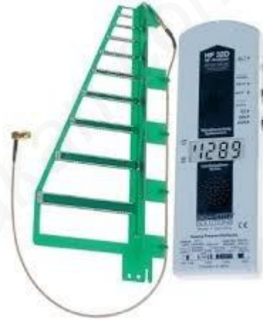
Şekil 3: Mikrodalgaları kabaca ölçen bir alet
